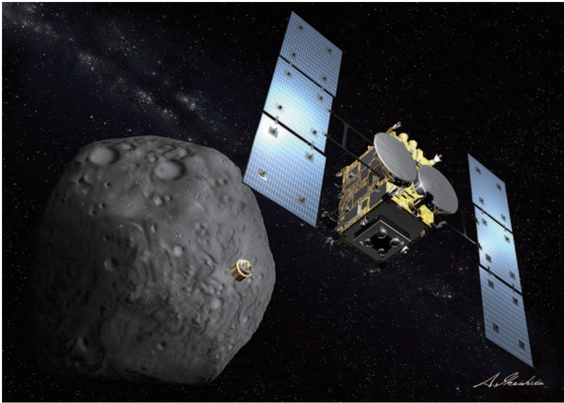
分離された SCI (Small Carry-on Impactor、直径 30cm) とはやぶさ 2 (予想図) ©イラスト：池下章裕
