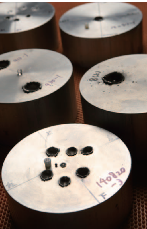
試験装置の照準を合わせるために使用されたアルミニウムの標的。上に置かれているのは、それぞれの衝突で使用されたのと同じプロジェクトイル。
