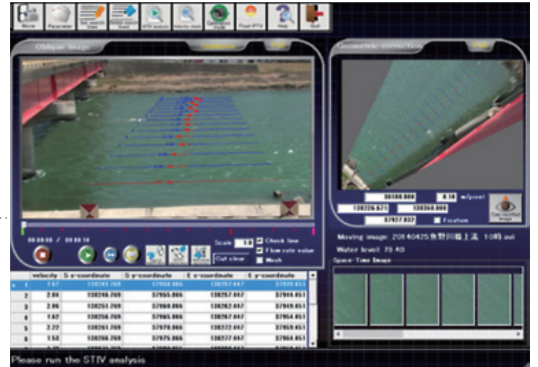
藤田教授が開発した「KU-STIV」の操作画面。河川の映像に基準となる検査線を配置し（画面左上）、波紋や浮遊物が通過した時間から流速を求め、その分布を分析して間接的に流量を推定する。川岸から（横から）撮影した映像を、真上から見た映像に幾何補正し（画面右上）、1つ1つは短時間で消滅する波紋の軌跡を多数積み重ねた時空間画像（Space-Time Image）を解析することで流速（Velocity）が得られる。
