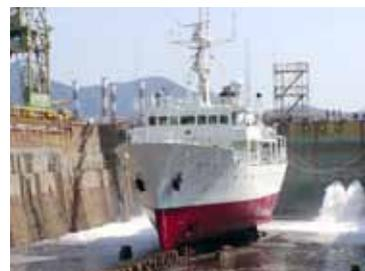
図 3 ドライドック注水（船体浮上）風景
