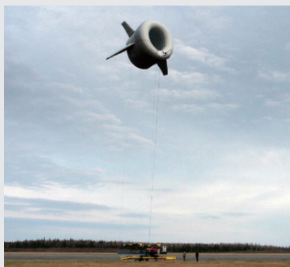
図1 空中浮体式風力発電機BAT (Altaeros Energies Homepageより)
